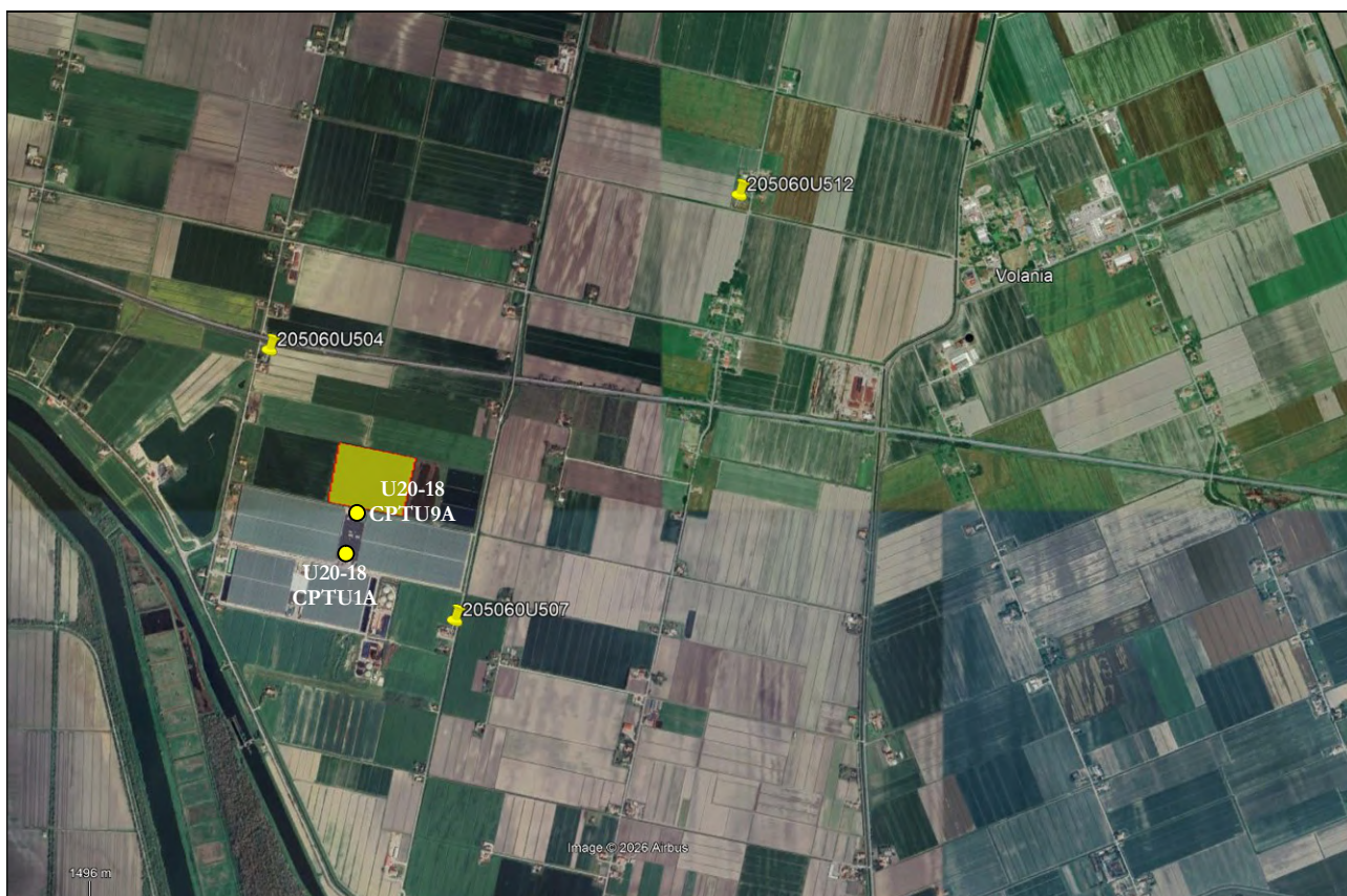
FIGURA 2.5 – Ortofoto dell'area con l'ubicazione delle prove CPTU e dei sondaggi svolti in sito
