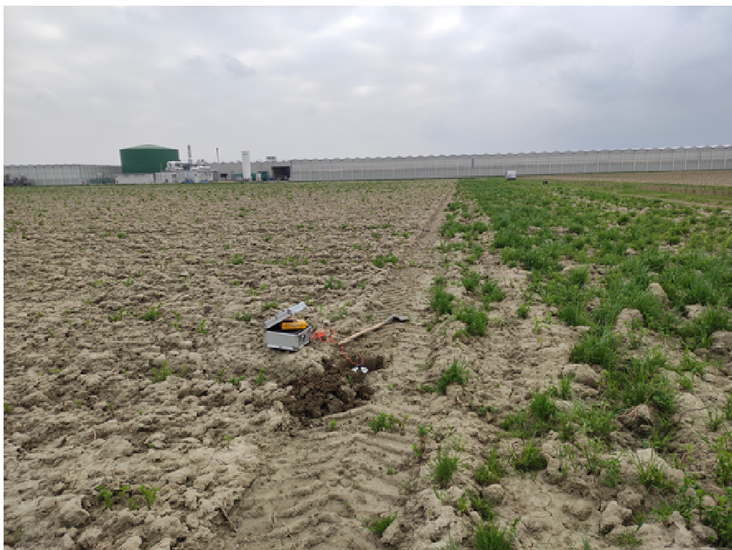
Figura 4: particolare della fase di acquisizione die microtremori della prov1 "H/V-02" effettuate nell'area. Vista verso S.
